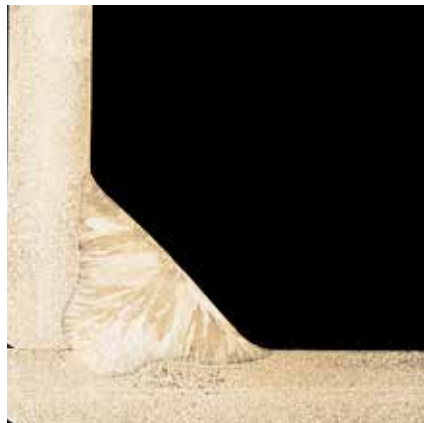
PB MAG (135) - spoina pachwinowa, austenityczna stal nierdzewna o grubości 3mm, gaz osłonowy Inolinx® MAG.
