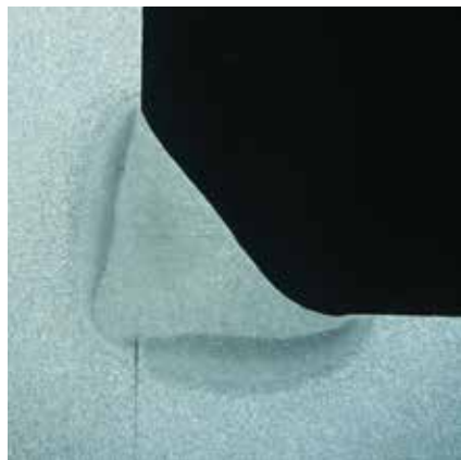
PB MAG (135) – spoina pachwinowa, stal węglowa o grubości 8mm, gaz osłonowy Ferrolinx® C.
